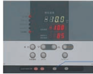
水位监测、冷冻机监测、冷冻机动作指示器
